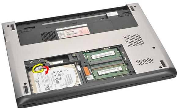
7. Retirez les vis qui fixent le support du disque dur à ce dernier. Disjoignez le support du disque dur.
