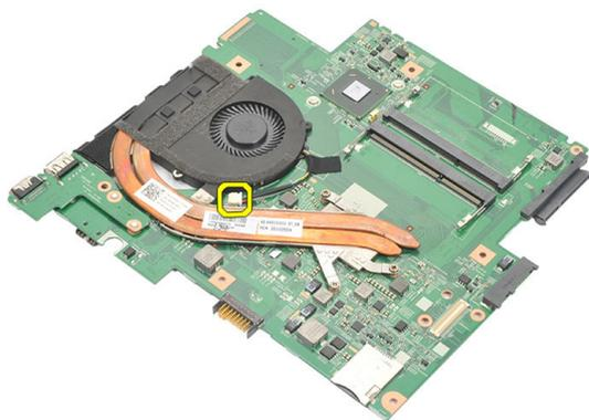
15. Desserrez les vis imperdables qui fixent le dissipateur thermique à la carte système.
