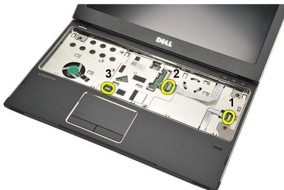
9. Avec une pointe en plastique, dégagez délicatement les côtés du repose-mains et retirez ce dernier de l'ordinateur.
