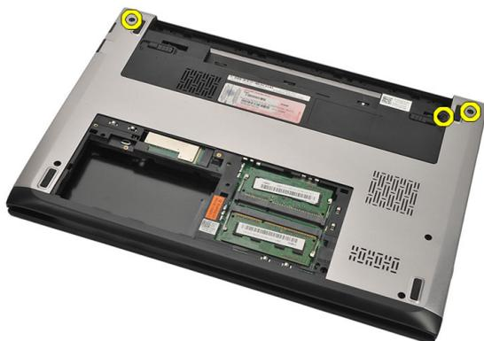
8. Retournez l'ordinateur. Débranchez les câbles WLAN et WWAN et désacheminez-les du châssis de base.
