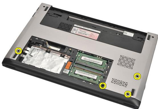
7. Retirez les vis situées sur le repose-mains.
